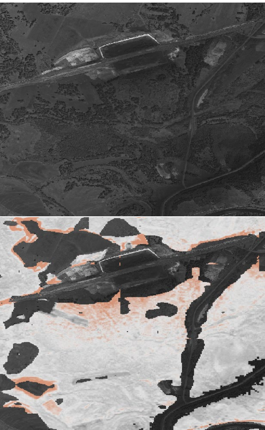
Rys. 8. Fragment obszaru lokalizacji 1 z widocznym nowym przobrażonym obszarem w roku 2021 (góra); porównanie wartości wskaźnika NDVI pomiędzy 2017 a 2022 (dół).
